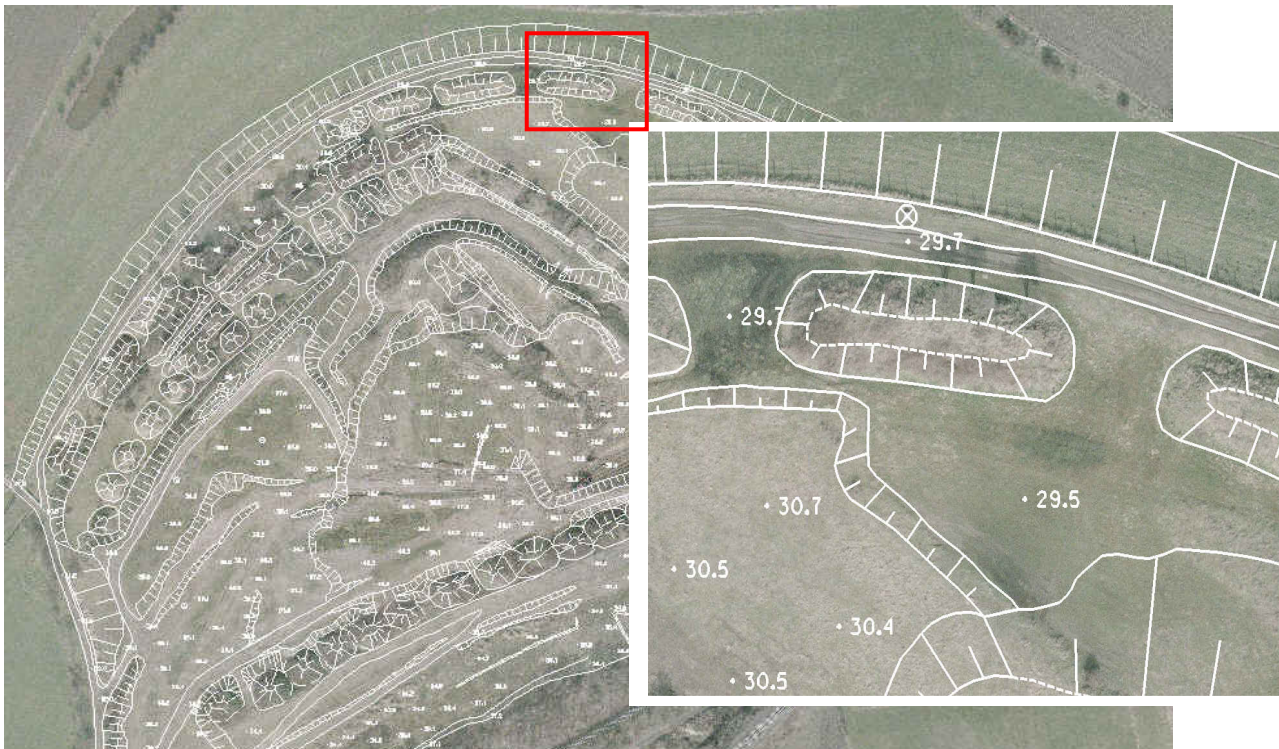
Deponie: Höhenpunkte und Böschungsschraffuren mit hinterlegtem Luftbild
