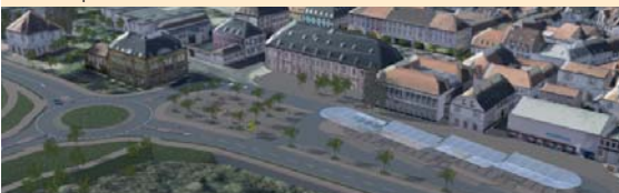
Трёхмерное изображение на основе лазерного сканирования и ортофотоснимков, совмещённое с проектируемыми элементами.
