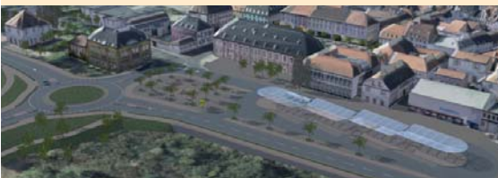
Vue oblique 3D à partir de données laser et d'orthophotographies, avec superposition d'éléments de planification.
