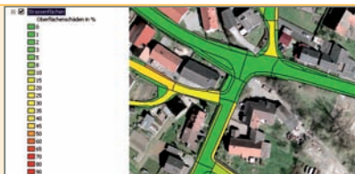
Zustandsdaten II: Visualisierung von Oberflächenschäden in %.
