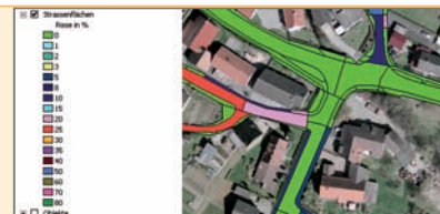
Zustandsdaten I: Visualisierung von Rissen in %.
